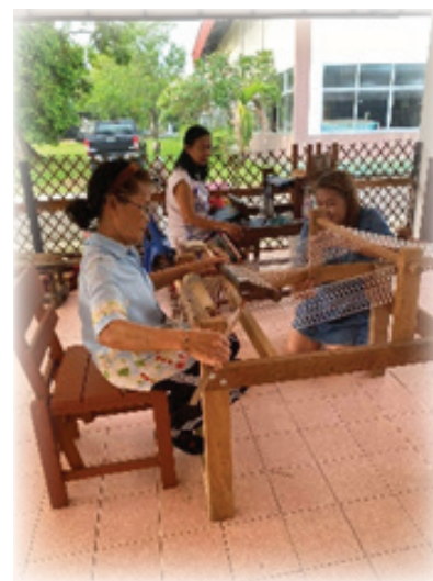
ภาพที่ 3 เครื่องทอเส้นที่ได้จากการพัฒนา เพื่อแก้ปัญหการนั่งที่ต้องก้มโน้มตัว
