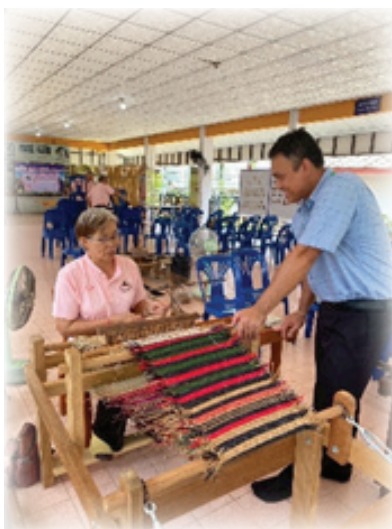
ภาพที่ 3 เครื่องทอเส้นที่ได้จากการพัฒนา เพื่อแก้ปัญหการนั่งที่ต้องก้มโน้มตัว
