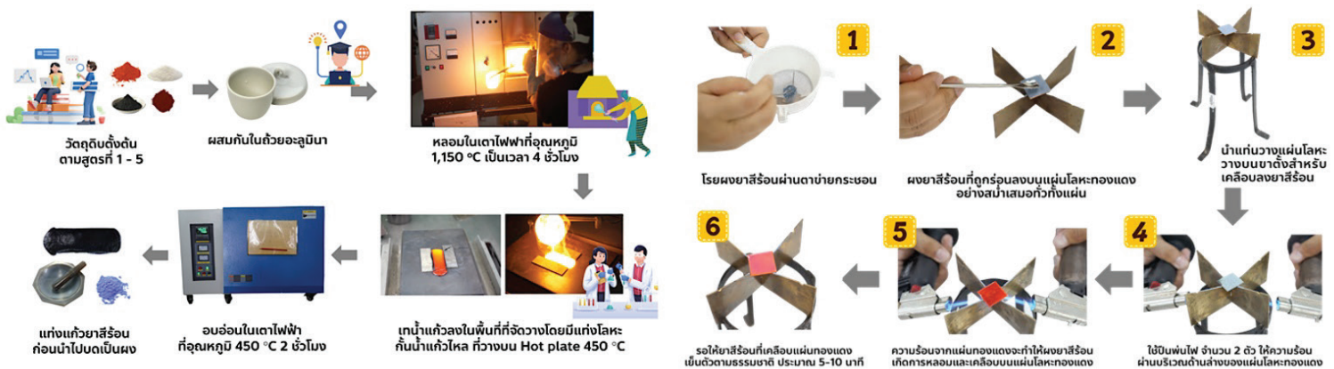
ภาพที่ 1 วิธีการผลิตยาสีร้อนสีน้ำเงินเข้มและวิธีการเคลือบยาสีร้อนลงบนแผ่นทองแดง
