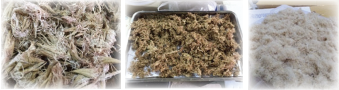
ภาพที่ 1 ลักษณะเส้นใยแห้งจากเปลือกทุเรียนขนาดต่าง ๆ ที่พร้อมสำหรับการเก็บไว้ใช้งานต่อไป
