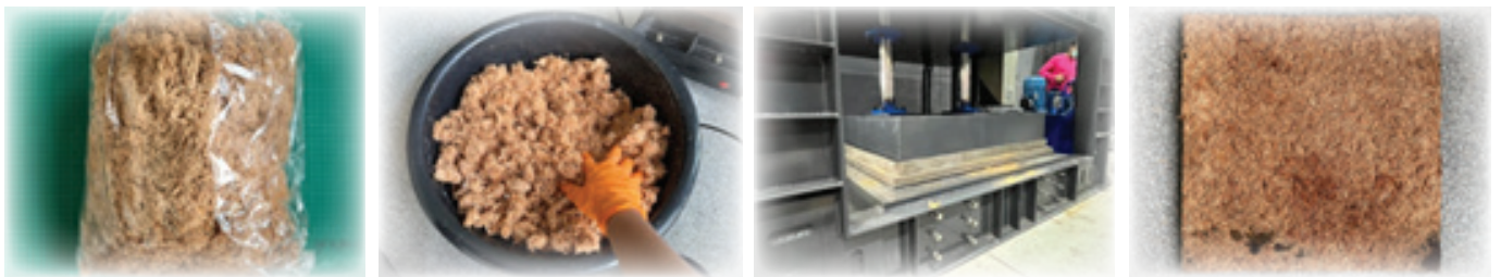
ภาพที่ 2 การผสมเส้นใยจากเปลือกทุเรียนกับกาวยูเรียฟอร์มัลดีไฮด์ และทำการอัดแผ่นชั้นไม้อัดด้วยเครื่องอัดไฮดรอลิกแบบอัดร้อน
