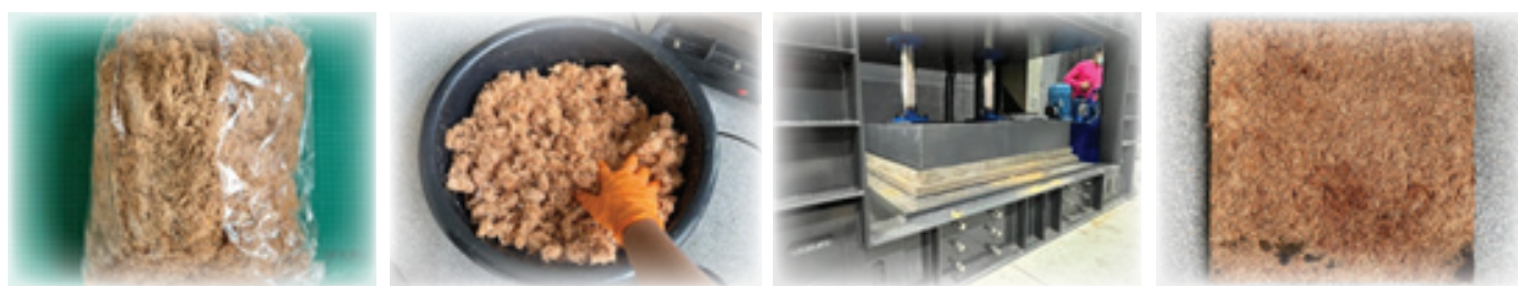
ภาพที่ 2 การผสมเส้นใยจากเปลือกทุเรียนกับกาวยูเรียพอร์มัลดีไฮด์ และทำการอัดแผ่นชั้นไม้อัดด้วยเครื่องอัดไฮดรอลิกแบบอัดร้อน
