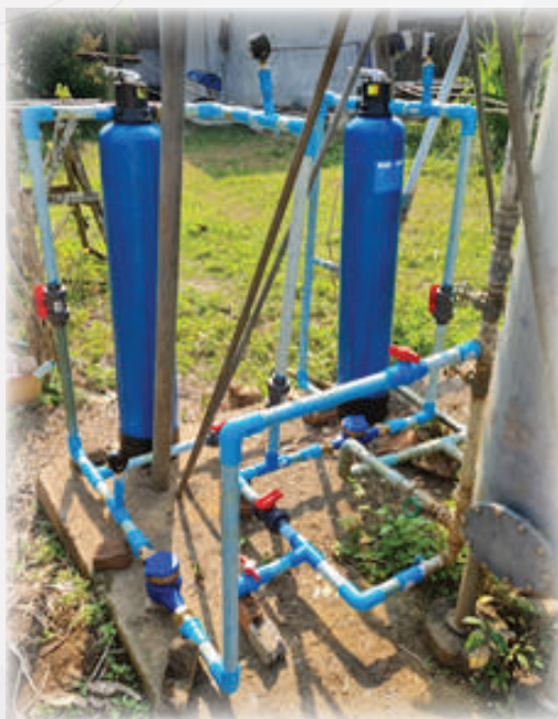
รูปที่ 1 ระบบทดสอบการกรองเมื่อประกอบเสร็จ
