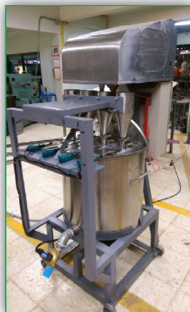
ภาพที่ 4 แสดงถังกวนสบู่มุนไพรมินิature ขนาดเล็กกึ่งอัตโนมัติ
